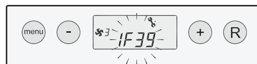
Vergrendelende systeemventilatorcode; storingsweergave knippert, verlichting aan
