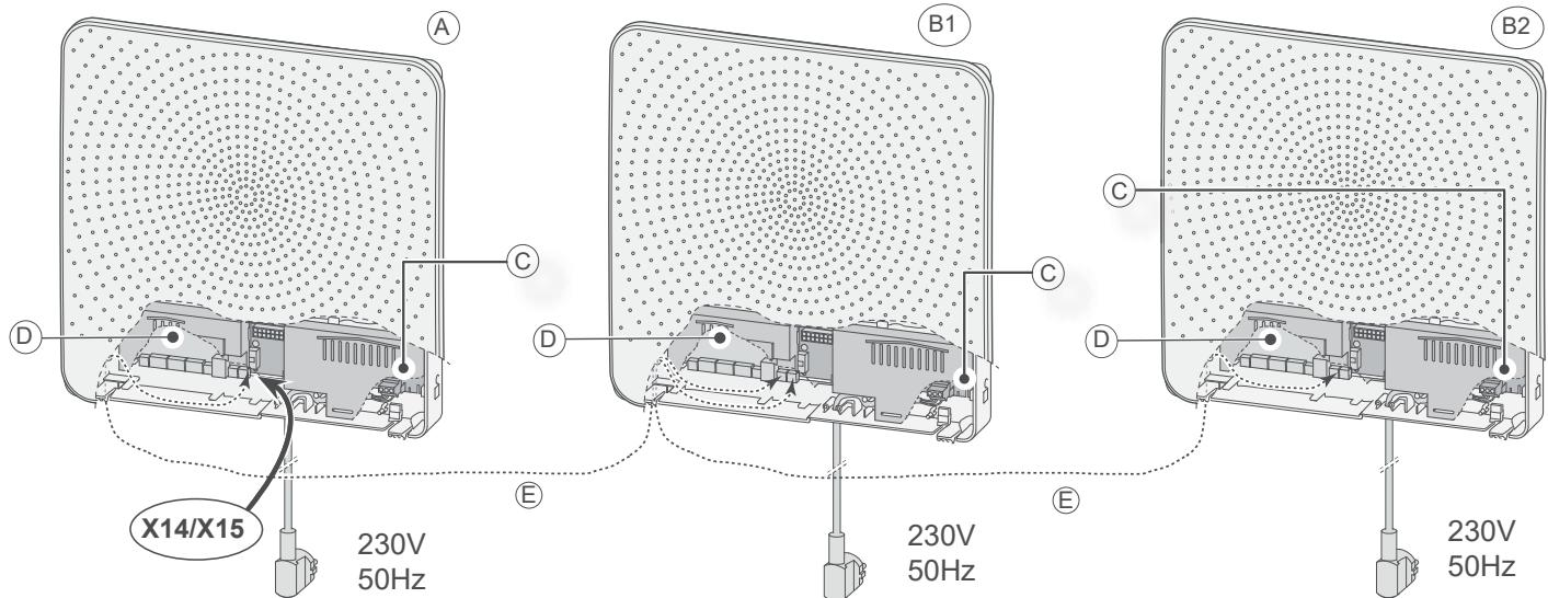
La position de ventilation de l'appareil maître (master) est reprise par les appareils esclaves (slave)
