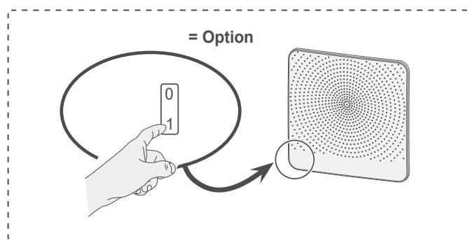
22 Remettre le compteur de filtre à zéro après avoir remplacé/ nettoyé les filtres (voir §8.1 point 7).
