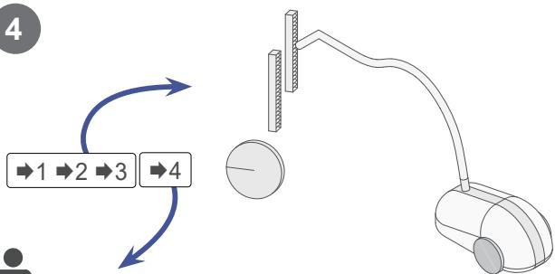
Lors des 3 premières alarmes d'encrassement des filtres, nettoyer les filtres avec un aspirateur; à chaque 4<sup>e</sup> alarme d'encrassement des filtres, remplacer les filtres (1 fois par an au moins) !
