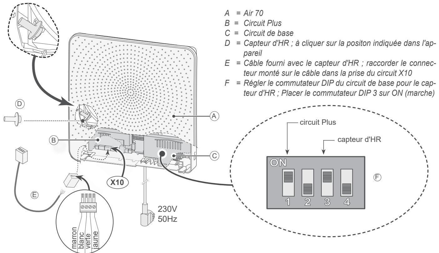
Si la sonde HR (capteur d'humidité relative) enregistre une augmentation du taux d'humidité ambiant pendant plusieurs minutes, le débit de ventilation sera automatiquement augmenté sur la position de ventilation 5.
