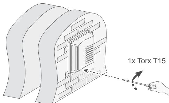
③ **ÉPAISSEUR DE MUR Y ENTRE 300 MM ET 500 MM**
