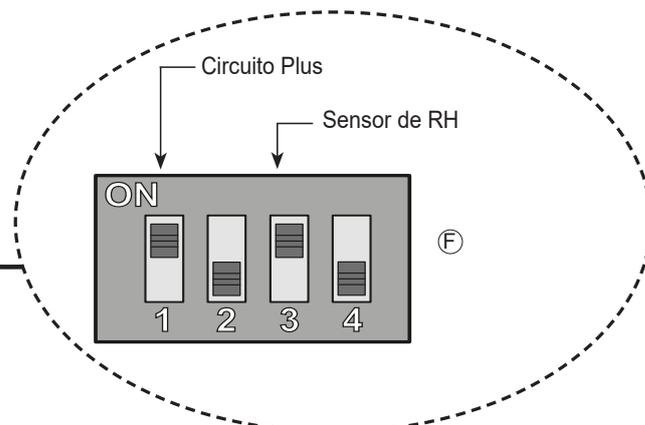
Si el sensor RH (sensor de humedad) detecta durante unos minutos un aumento de la humedad ambiental, la capacidad de ventilación aumenta automáticamente a la posición 5 de ventilación.
