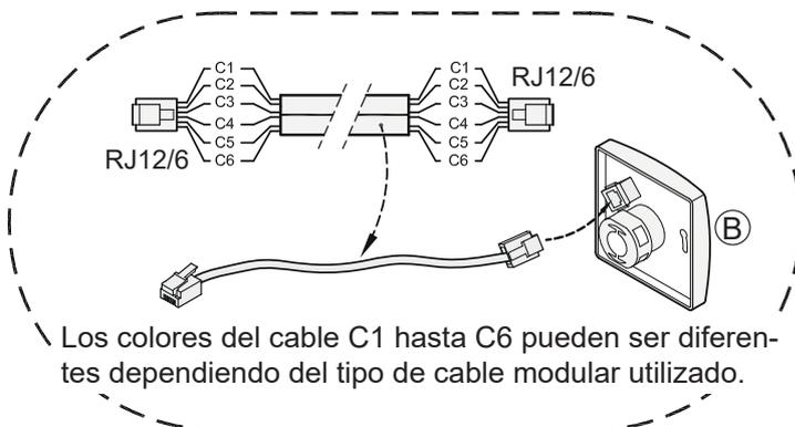
Los colores del cable C1 hasta C6 pueden ser diferentes dependiendo del tipo de cable modular utilizado.
