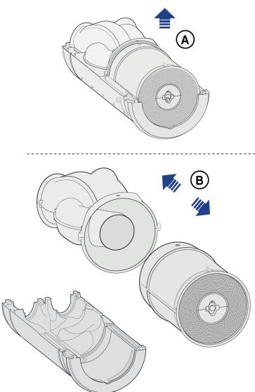
10. Vysávačom a jemnou kefou vyčistite sekciu ventilátora aj výmenník tepla.
