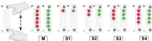
3. Výber uložte stlačením a podržaním dvoch tlačidiel minimálne na 3 sekundy, pozri obr. A. Uložené nastavenie trikrát zabliká nazeleno.
