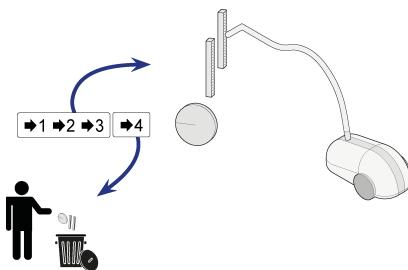
Pri prvých 3 hláseniach filtra vycistite filtro vysávačom; pri každom 4. hlásení filtro vymeňte filtro (minimálne 1-krát ročne).
