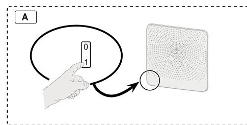
A = voliteľný spínač napájania
