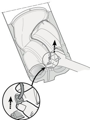
9. Sekciu ventilátora a výmenník tepla odstráňte zo sekcie z EPP (A). Následne posunutím odpojte sekciu ventilátora od výmenníka tepla (B).
