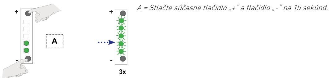
Všetky zmenené nastavenia sa vynulujú na pôvodné hodnoty, s ktorými sa zariadenie Air 70 dodáva z výroby. Všetky uložené správy o poruchách sa vymažú a vynuluje sa aj hlásenie filtra.
