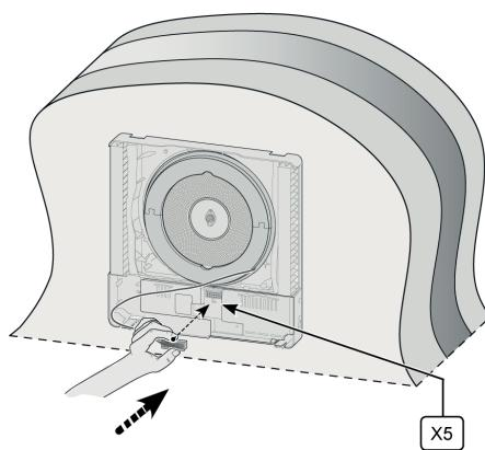
19. Nainštalujte nové filtre; dbajte na polohu šípok na filtroch.
