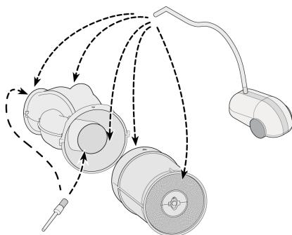
11. Ak je to možné, nízkotlakovým prúdom vzduchu (max. 0,5 bar) vyfúkajte nečistoty z vnútrajška výmenníka.
