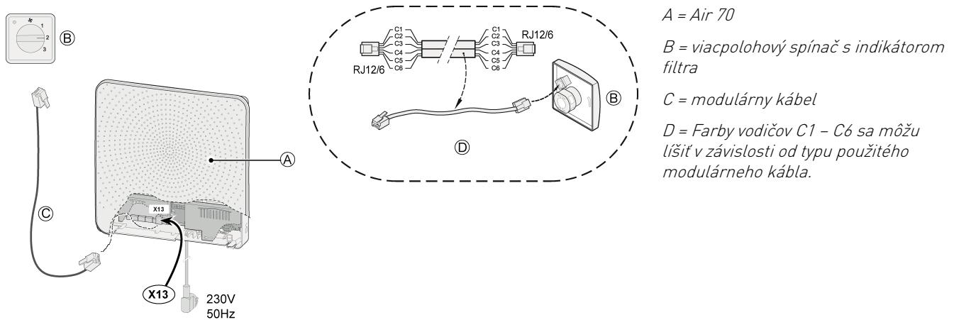
Pri použití modulárneho kábla musí byť „jazýček“ oboch modulárnych konektorov namontovaný tak, aby smeroval k značke na modulárnom káble.
