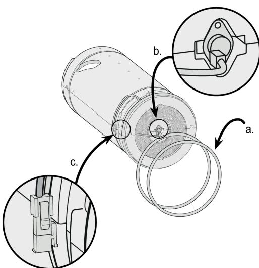
7. Odpojením hornej sekcie od dolnej sekcie sprístupnite výmenník tepla a kryt snímača.
