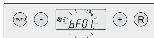
Vergrendelende systeemventilatorcode; storingsweergave knippert, verlichting aan
