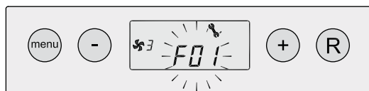
Vergrendelende storing; toestel storing Storingsweergave knippert
