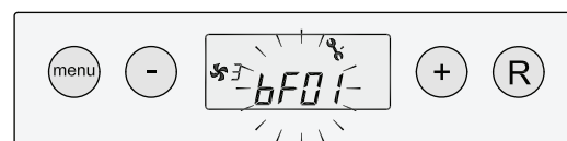
Vergrendelende systeemventilatorcode; storingsweergave knippert, verlichting aan
