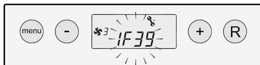
Dérangement verrouillant ; dérangement du ventilateur
