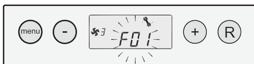
Vergrendelende storing; toestel storing Storingsweergave knippert
