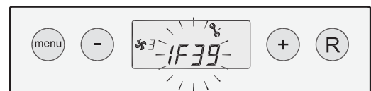
Vergrendelende systeemventilatorcode; storingsweergave knippert, verlichting aan
