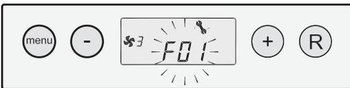
Sperrstörung; Gerätestörung; Störungsnummer blinkt
