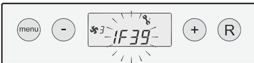
Sperrstörung; Ventilatorstörung; Störungsnummer blinkt
