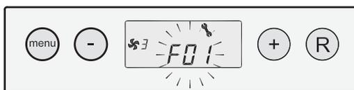
Sperrender Gerätecode; Störungsanzeige blinkt, Beleuchtung Ein
