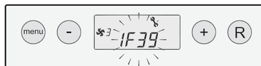
Sperrender Systemventilatorcode; Störungsanzeige blinkt, Beleuchtung Ein
