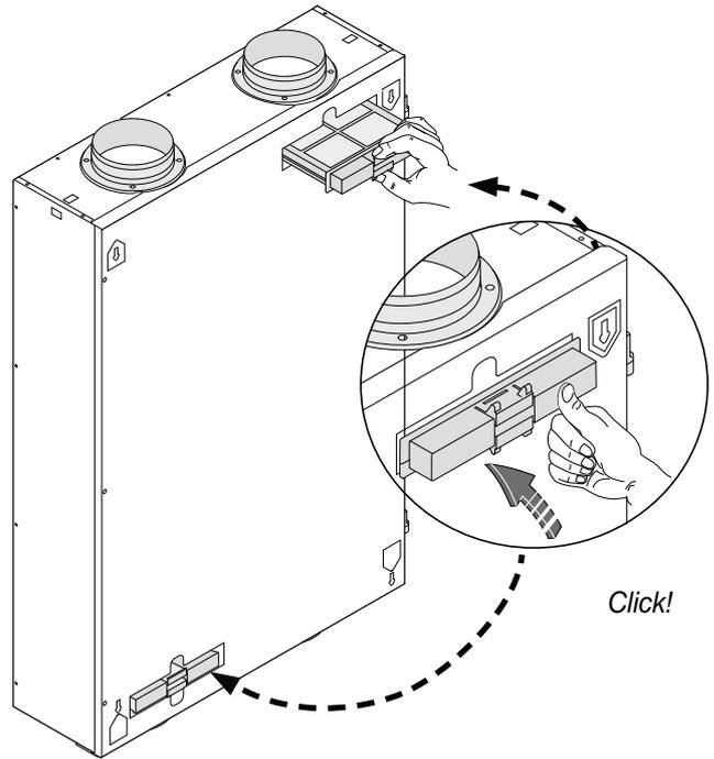
5 Nach der Reinigung bzw. dem Austausch der Filter die Filterstatusanzeige zurücksetzen, indem die Return-Taste (↩) am Bedienmodul 5 Sekunden lang betätigt wird. Der Text 'FILTER' im Display des Bedienmoduls wird zur Bestätigung, dass der 'Zähler' zurückgesetzt wurde, ausgeblendet. Die rote LED am gegebenenfalls angeschlossenen Stufenschalter ist auch wieder erloschen.
