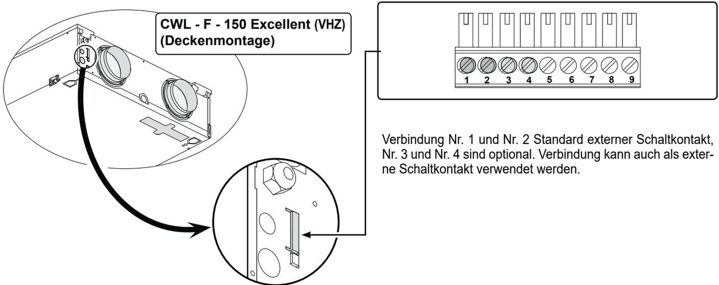
Durch Anpassung der Schrittnummer 16 können beim Schließen des Eingangs des externen Schaltkontakts 1 (Nr. 1 und Nr. 2 an der 9-poligen Steckverbindung) fünf verschiedene Betriebsarten für Zu- und Abluftventilator eingestellt werden. Je nach der Einstellung der Schrittnummern 17 und 18 können der Zu- und Abluftventilator mit unterschiedlichen Luftmengen betrieben werden (höchste Luftmenge wird im Display angezeigt).
