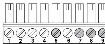
Klemme Nr. 5 (GND) und 9 (0-10V-Ausgang) für die Steuerung Erdwärmetauscher; Klemme Nr. 7 und 8 für Temperaturfühler (10 kΩ)
