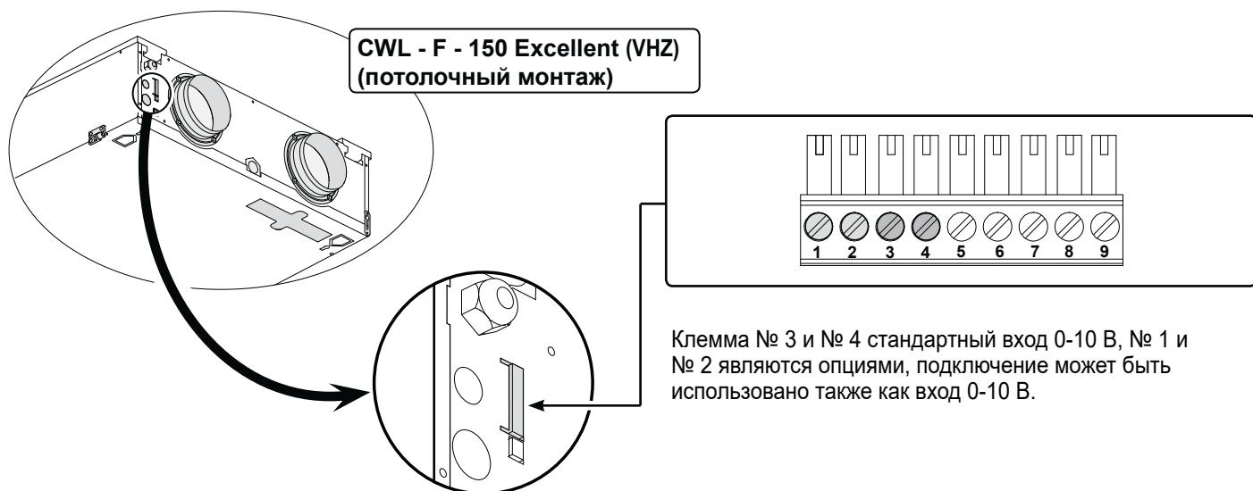
Если потребуется еще второй вход 0-10 В, можно при необходимости перепрограммировать на второй вход 0-10 В подключения № 1 и № 2 9-полюсного штекера X15, которые стандартно запрограммированы на переключающий контакт. Путем установки шага № 14 с 'AUS' \*ВЫКЛ.) на 'EIN' (ВКЛ.) данный вход становится пропорциональным входом 0-10 В. При использовании двух входов 0-10 В, вход 0-10 В с наивысшим расходом воздуха всегда имеет приоритет.
