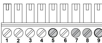
клемма № 5 (земля) и 9 (выход 0-10 В) для управления геотермальным теплообменником; клемма № 7 и 8 для датчика температуры (10 кОм)
