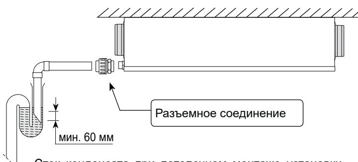
Сток конденсата при потолочном монтаже установки CWL - F - 150 Excellent (VHZ)
