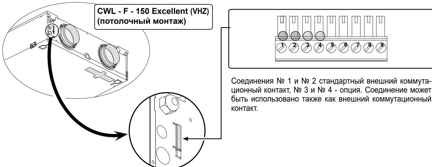
Изменением шага № 16 при замыкании входа внешнего коммутационного контакта 1 (№ 1 и № 2 9-полюсного штепсельного разъема) можно отрегулировать пять различных режимов работы приточного и вытяжного вентиляторов. В зависимости от параметров настройки шагов № 17 и 18 вентилятор приточного воздуха и вентилятор вытяжного воздуха могут работать с разными расходами воздуха (наивысший объем воздуха выдается на дисплей).
