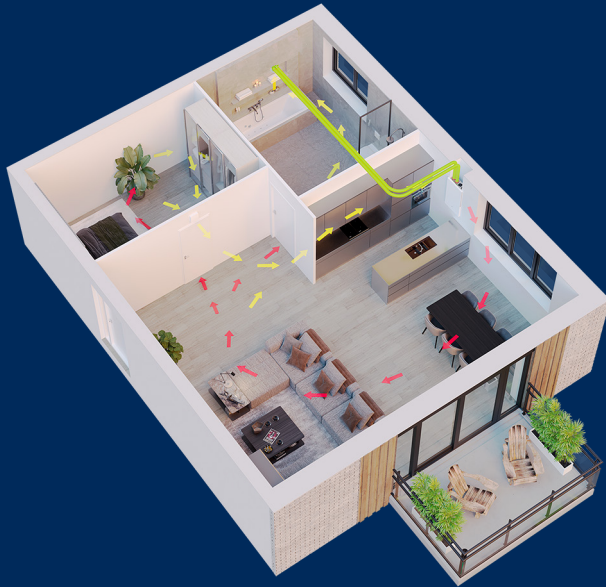
2-Zimmerappartement mit Ease 100 als semi-zentrales Gerät (in der Wand) mit zusätzlichem Indoor-Mixfan zwischen Wohn- und Schlafraum.
