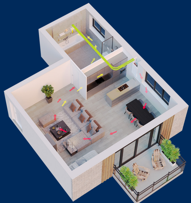
Studio mit Ease 100 als semi-zentrale Lüftung (in der Wand).
