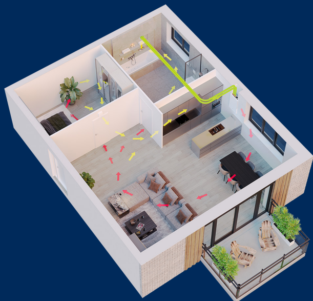
2-kamer appartement met Ease 100 als semi-centrale ventilatie (in de muur) met een extra indoor mixfan tussen woon- en slaapkamer.
