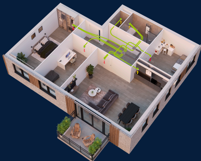
Ease 200 intégré dans le placard de cuisine d'un appartement.
