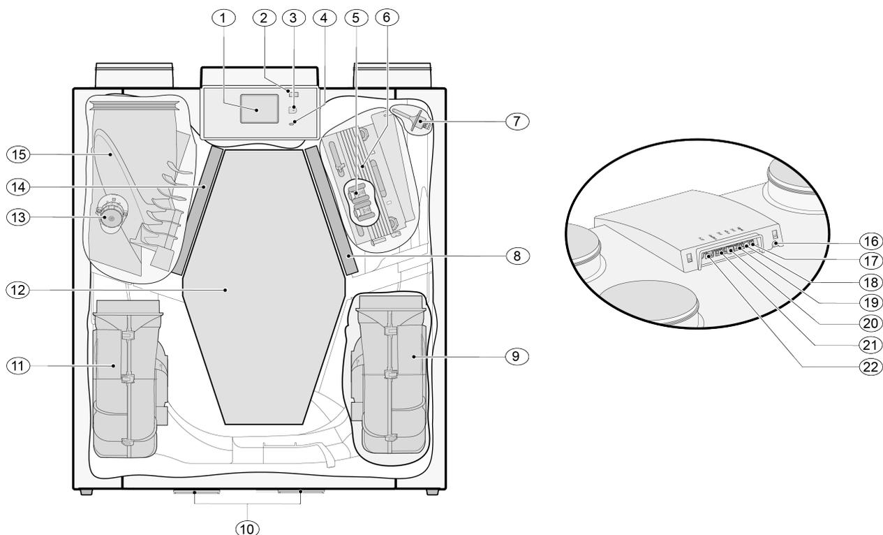
L'appareil illustré ci-dessus est une version gauche : dans le cas d'une version droite, le connecteur du préchauffeur et la vanne de bypass sont installés en miroir !
