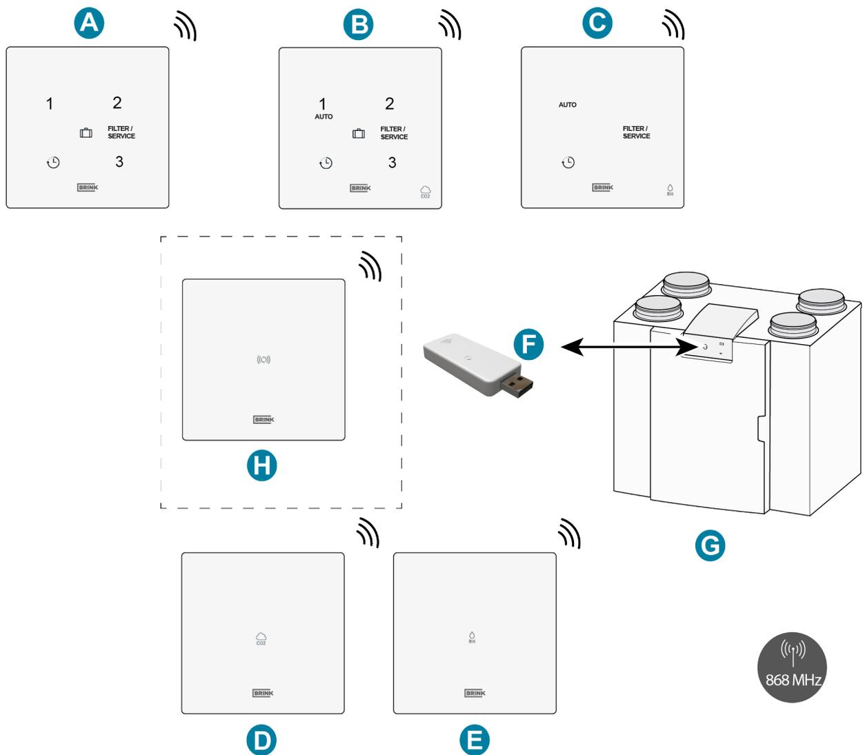
A = Kabelloser 3-Stufen-Schalter
