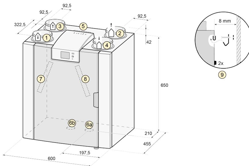
Alle Abmessungen sind in Millimeter angegeben. Der Durchmesser aller Anschlussmanschetten beträgt 125 mm.
