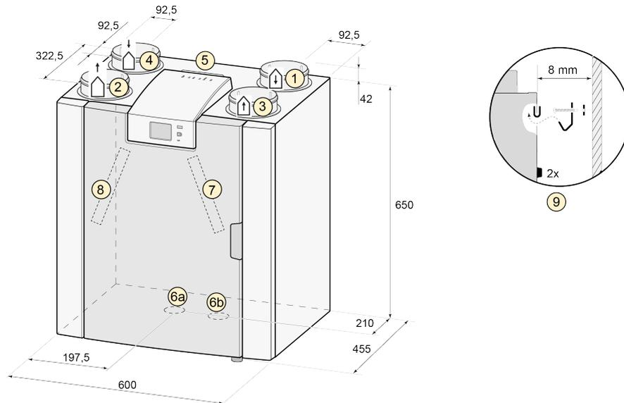
Alle Abmessungen sind in Millimeter angegeben. Der Durchmesser aller Anschlussmanschetten beträgt 125 mm.
