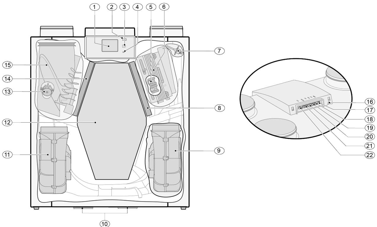
Bei dem oben abgebildeten Gerät handelt es sich um eine Linksausführung: Bei einer Rechtsausführung sind der Vorwärmer-Anschluss und das Bypassventil spiegelverkehrt eingebaut!
