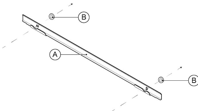
4. Installare i **2** cappucci protettivi adesivi (C) sul **lato posteriore** dell'apparecchio, a circa 50 mm dai bordi laterali e inferiore.
