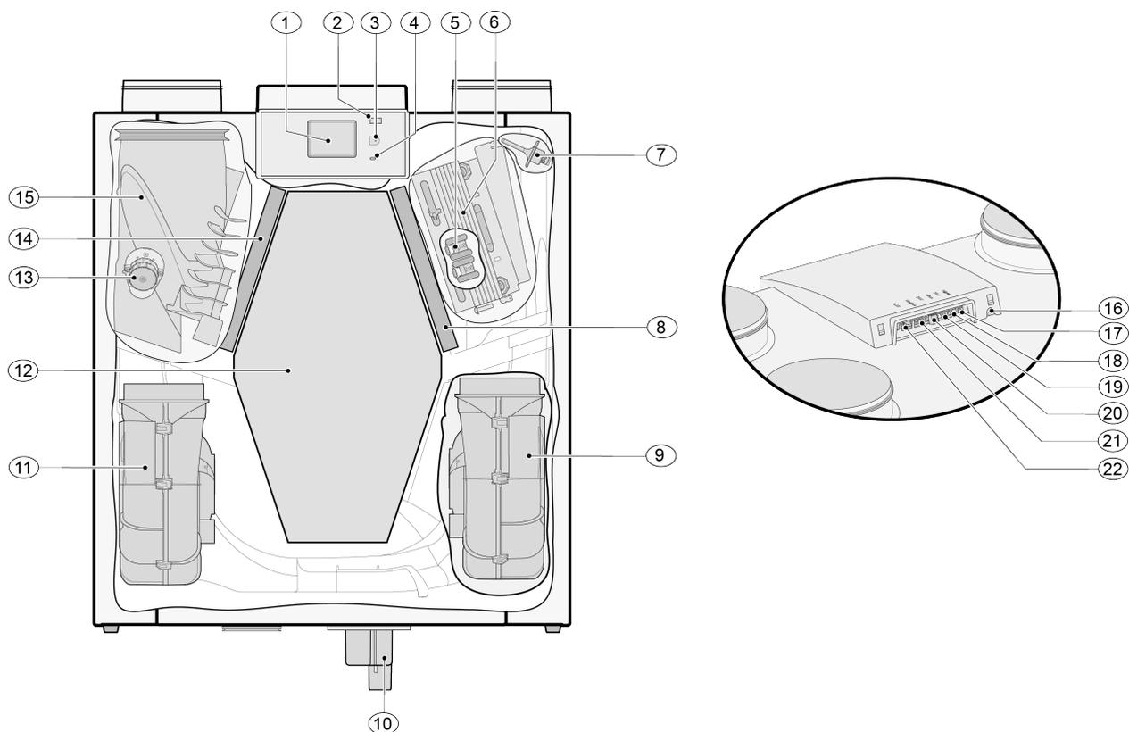
Naprava, prikazana zgoraj, je leva različica: v primeru desne različice so priključek predgrelnika, obvodni ventil in priključek sifona nameščeni v obratnem vrstnem redu!
