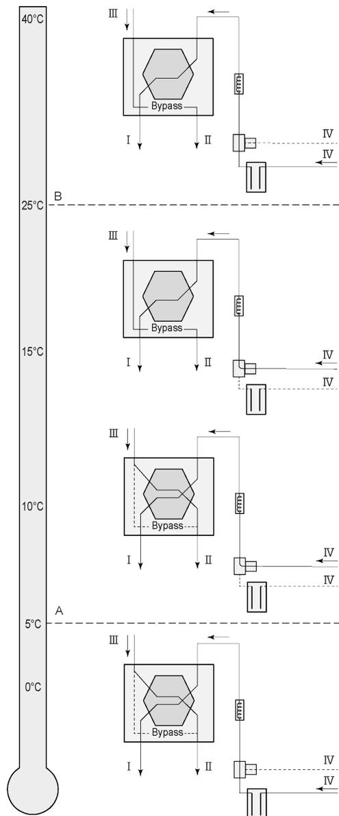
Na napravo Flair lahko s tiskanim vezjem (Plus) priključite geo izmenjevalnik toplote.
