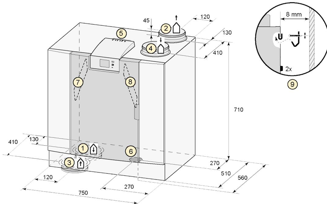
Alle Abmessungen sind in mm angegeben. Der Durchmesser sämtlicher Bundringe beträgt 160 mm.
