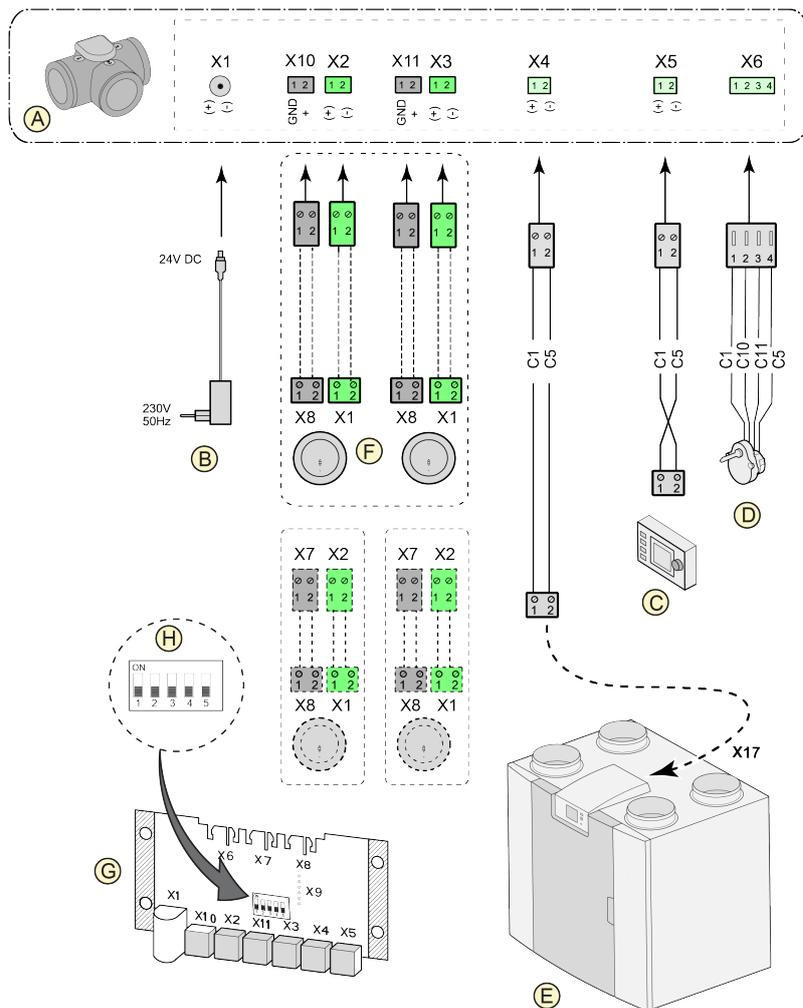
A = Zonenventil für bedarfsgesteuerte Belüftung
