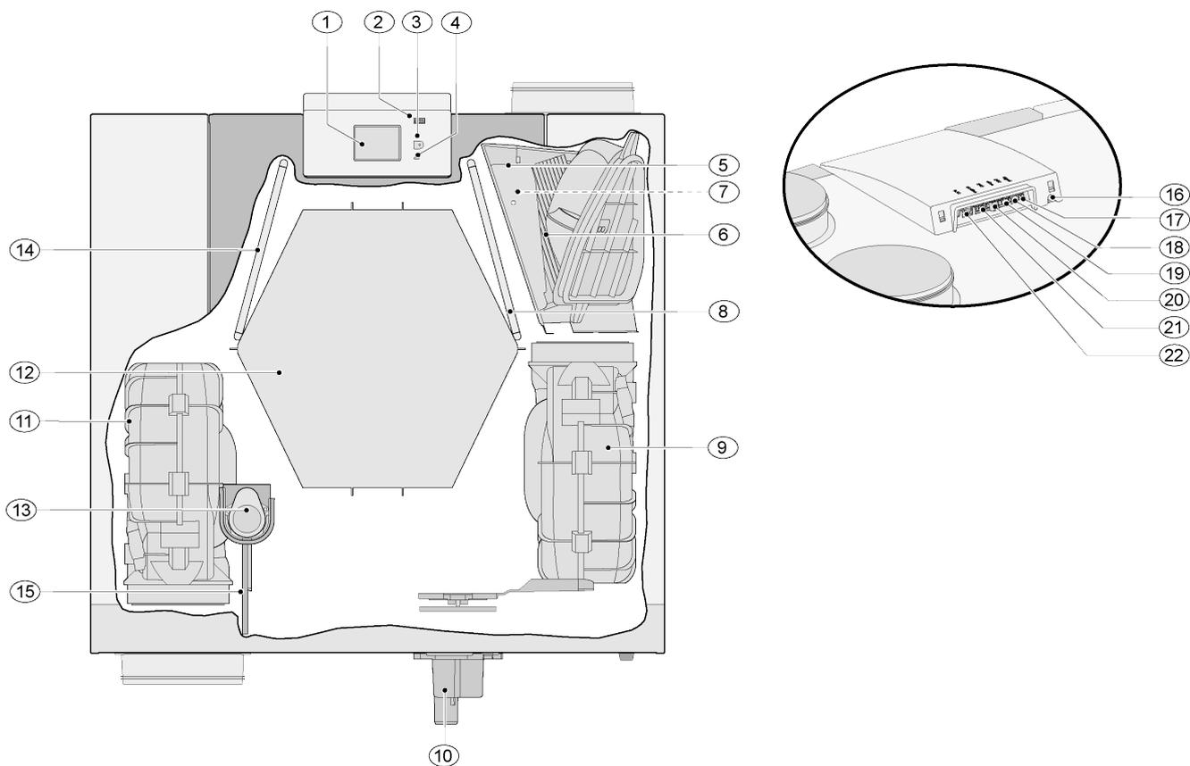
Bei dem oben abgebildeten Gerät handelt es sich um eine Linksausführung: Bei einer Rechtsausführung sind der Vorwärmer-Anschluss, das Bypassventil und der Siphon-Anschluss spiegelverkehrt eingebaut!
