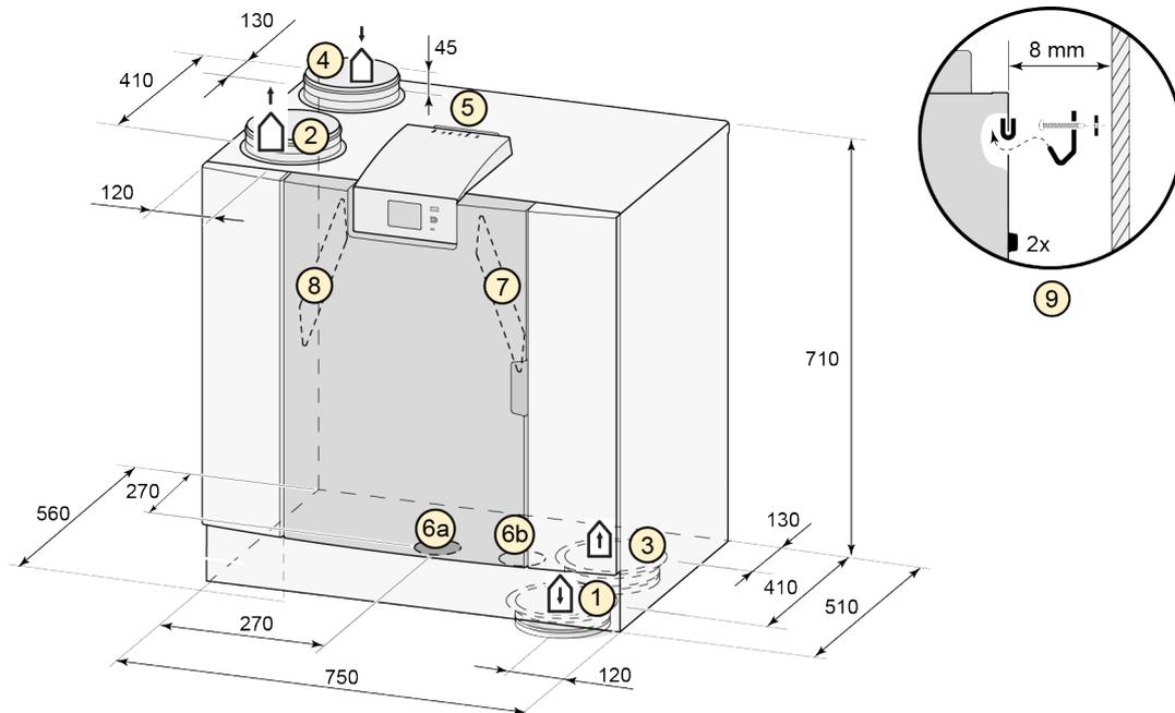
Tutte le dimensioni sono espresse in millimetri. Tutti i collari hanno un diametro di 160 mm.
