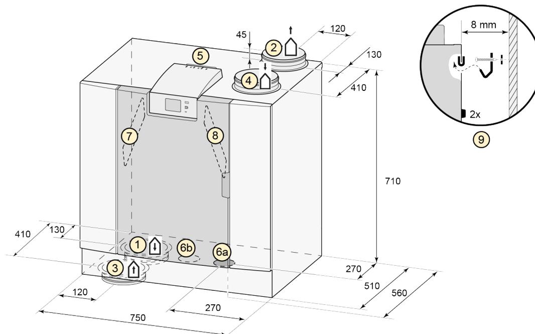
Tutte le dimensioni sono espresse in millimetri. Tutti i collari hanno un diametro di 160 mm.
