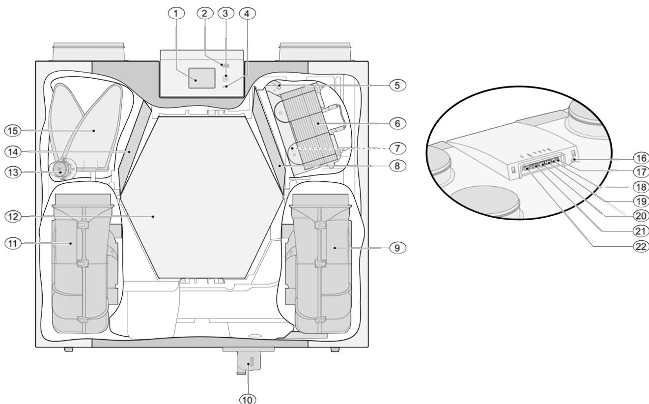
El sistema mostrado anteriormente es una versión con configuración en el lado izquierdo: en el caso de una versión con configuración en el lado derecho, el conector del precalentador, la válvula de desviación y el conector del sifón se instalan invirtiendo la imagen.
