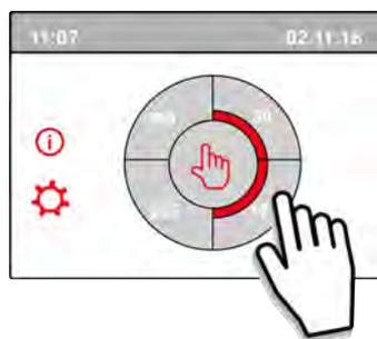
La pantalla táctil también se puede configurar permanentemente como interruptor múltiple. Para ello, configure el paso 15.6 del menú de configuración como "sí".
