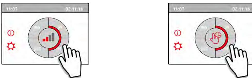
Si pulsa uno de los cuartos de círculo de la pantalla principal, podrá ajustar rápidamente el modo de ventilación. El modo de ventilación configurado así permanece activo media hora. Esto se indica en la pantalla mediante una mano con un reloj.
