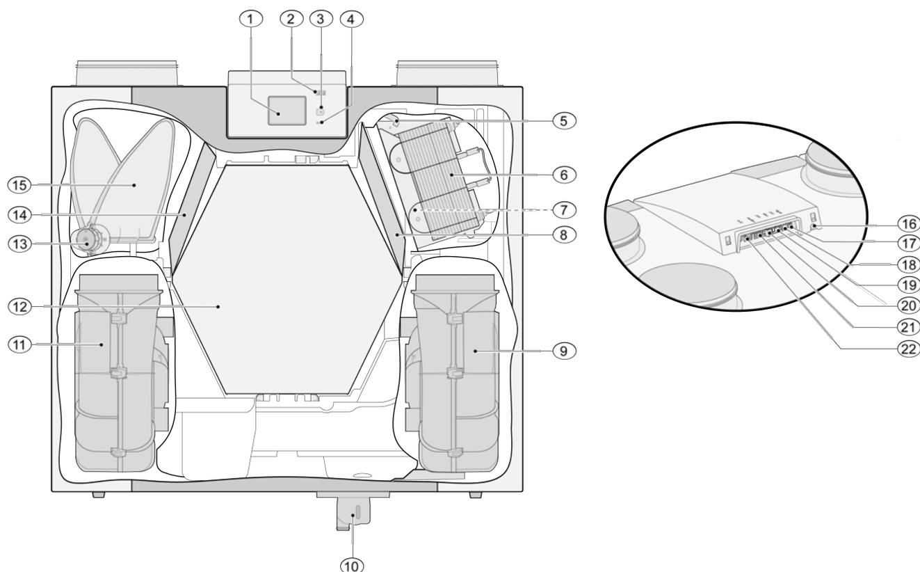
L'apparecchio rappresentato sopra è una versione sinistra: nella versione destra il collegamento del preriscaldatore, la valvola bypass e il collegamento del sifone sono installati in modo speculare!
