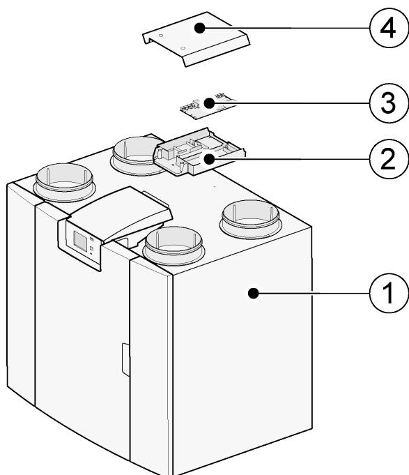
1 =naprava Flair 325 z nameščeno PCB Basic
