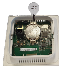
Tagumine seinaklamber, mis on paigaldatud kahepoolse teibiga.
