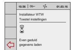
Figuur 6 Parameter CV+WTW activeren bij Renovent Sky 150 & Sky 300 met Brink Air Control
