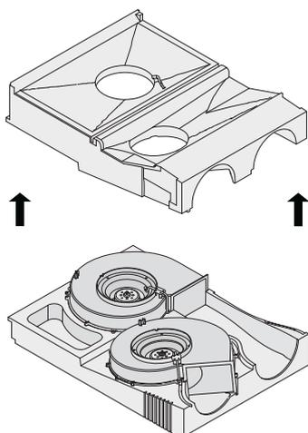
11 Die Ventilatoren mit einer weichen Bürste reinigen. **Die Druckausgleichsgewichte dürfen nicht verschoben werden!**
