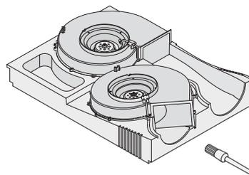
12 Das entfernte Ventilatorteil wieder anbringen und die entfernten Druckschläuche wieder an die Druckröhrchen anschließen.
