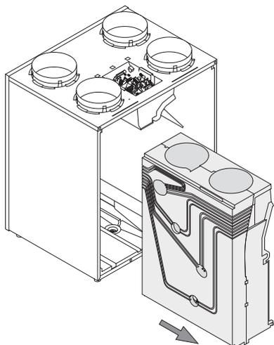
9 Das Ventilatorteil auf einen flachen Untergrund mit den Druckschläuchen nach oben legen. Den roten und den blauen Druckschlauch ohne schwarze Markierung von den im Ventilatorteil montierten Druckröhrchen entfernen. Jetzt das Schaumteil umdrehen, so dass das Teil mit den Druckschläuchen nach unten weist.
