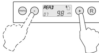
Wird 5 Min. keine Taste betätigt, kehrt das Gerät automatisch in die Betriebsart 'Betrieb' zurück.
