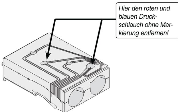
10 Das Ventilatorteil kann jetzt vorsichtig geteilt werden, so dass beide Ventilatoren erreichbar sind. Bitte achten Sie darauf, dass die Ventilatoren im unteren Ventilatorteil liegen bleiben!
