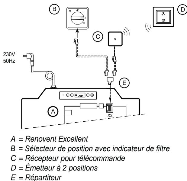
**11.4 Connexion au moyen d'un contact eBus ; tous les appareils ont le même débit d'air;**
