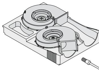
12 Reposer l'élément de partie de ventilateur et rebrancher les conduites de pression débranchées aux tubulures.
