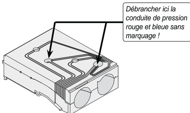
10 La partie ventilateur peut maintenant être prudemment séparée de façon à ce que les deux ventilateurs soient accessibles; veiller à ce que les ventilateurs reposent dans la partie ventilateur inférieure !
