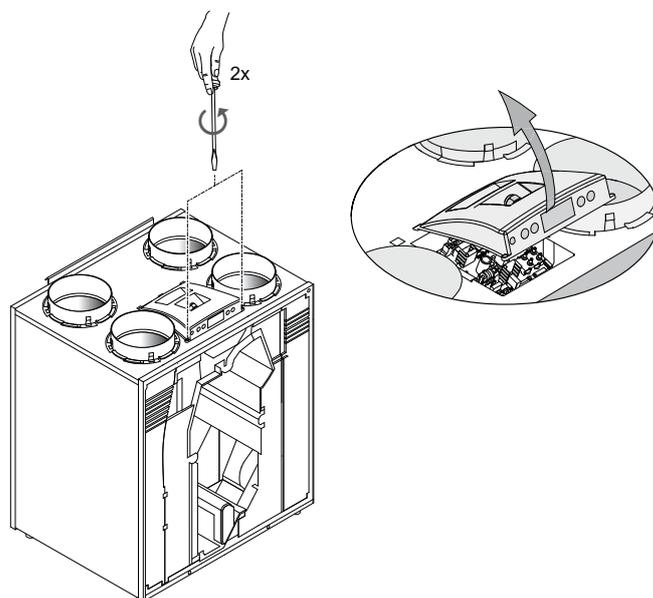
7 Débrancher les 4 conduites de pression et les 3 connecteurs du circuit imprimé.
