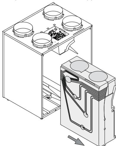
9 Poser la partie ventilateur sur une surface plane avec la conduite de pression sur le dessus. Déposer la conduite de pression rouge et bleue sans marque noire, des tubulures de pression montées dans la partie ventilateur. Retourner la partie mousse de façon à ce que la partie à conduites de pression se tourne vers le bas.
