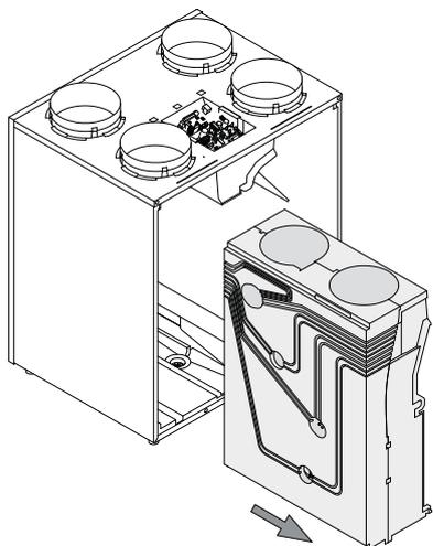
9. Padėkite ventiliatorių bloką ant plokščio paviršiaus taip, kad slėgio žarnos būtų viršuje. Nuimkite nuo slėgio vamzdžių, sumontuotus ventiliatorių bloke, raudoną ir mėlyną slėgio žarną be juodos žymos. Apsukite putplasčio bloką taip, kad blokas su slėgio žarnomis būtų nukreiptas žemyn.
