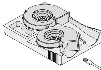
12. pakeiskite atskirtą ventiliatorių bloko dalį ir prie slėgio vamzdžių iš naujo prijunkite nuimtas slėgio žarnas. **Užtikrinkite, kad į slėgio vamzdžius nepatektų purvo!**
