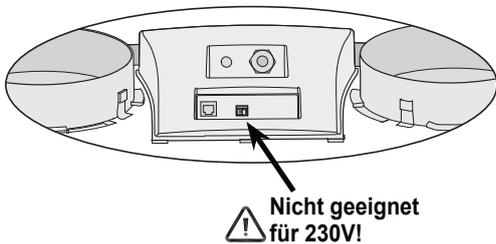
**Ebus bzw. OpenTherm-Steckverbindung X1**
