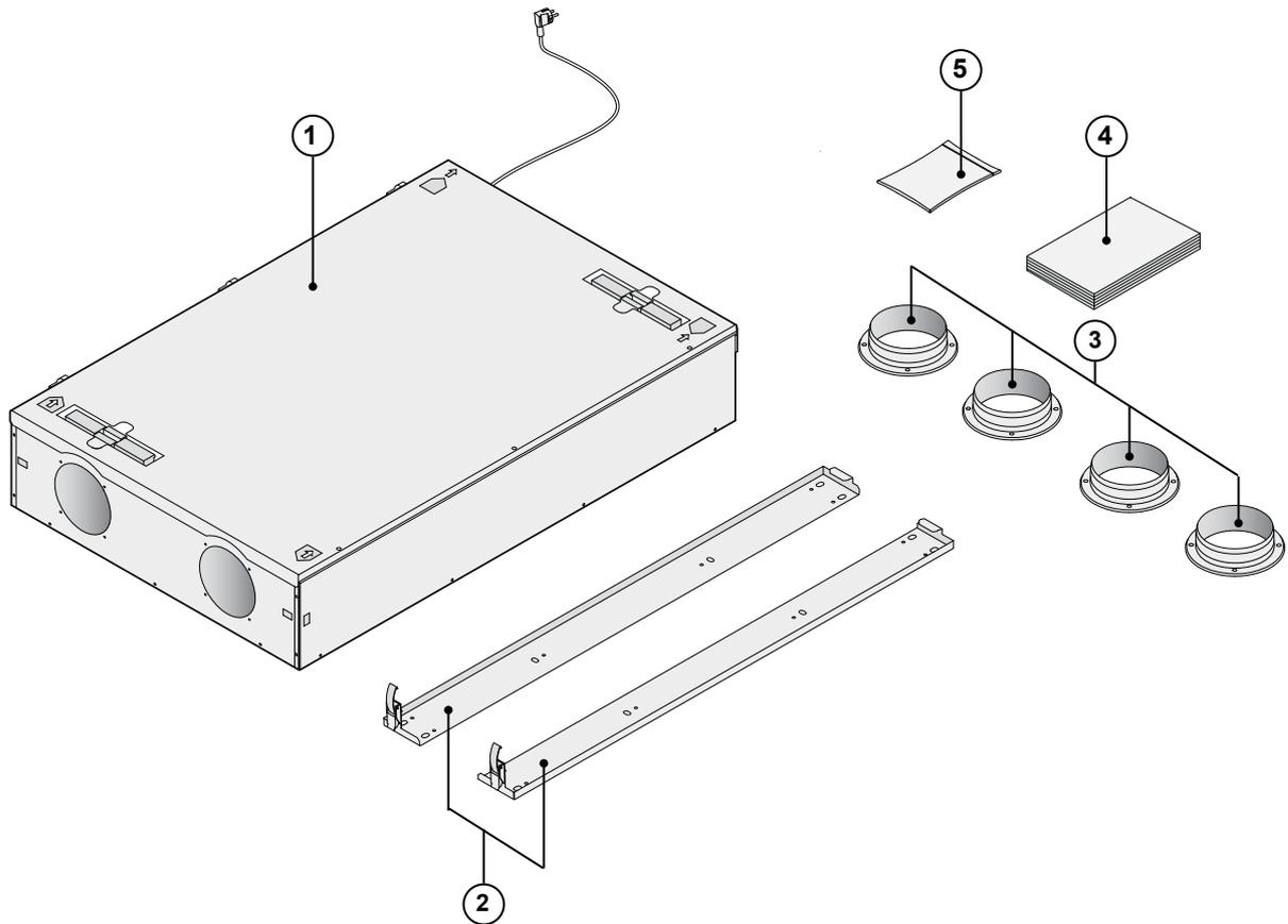
Bitte überprüfen Sie, bevor Sie mit der Installation des Wärmerückgewinnungsgeräts beginnen, ob es komplett und unbeschädigt geliefert wurden. Der Lieferumfang des Wärmerückgewinnungsgeräts vom Typ Renovent Sky 150 umfasst folgende Komponenten:
