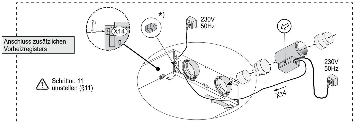
9.7 Anschluss Erdwärmetauscher
