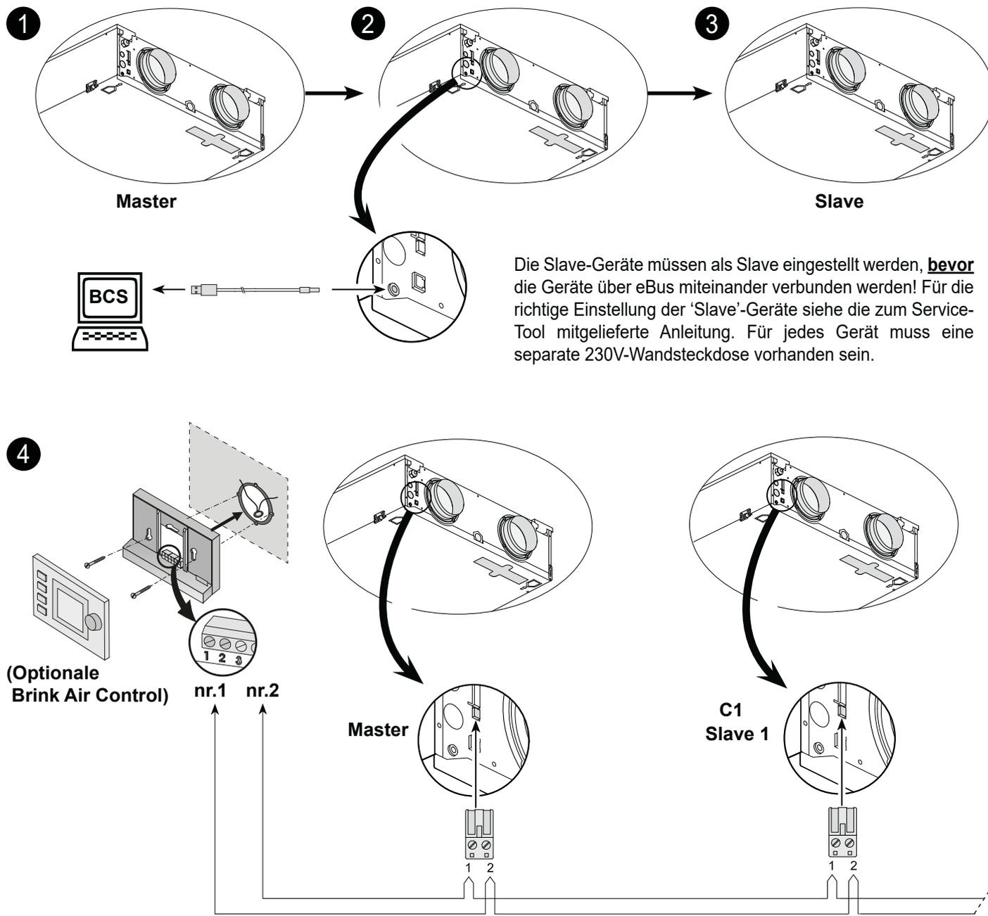
Die Slave-Geräte müssen als Slave eingestellt werden, **bevor** die Geräte über eBus miteinander verbunden werden! Für die richtige Einstellung der 'Slave'-Geräte siehe die zum Service-Tool mitgelieferte Anleitung. Für jedes Gerät muss eine separate 230V-Wandsteckdose vorhanden sein.
