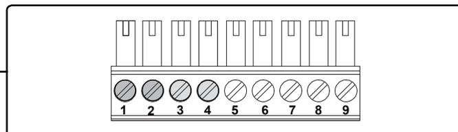
Připojení č. 1 a 2 jsou standardními kontakty externího přepínače; v případě potřeby je jako kontakty externího přepínače použít i připojení č. 3 a 4.
