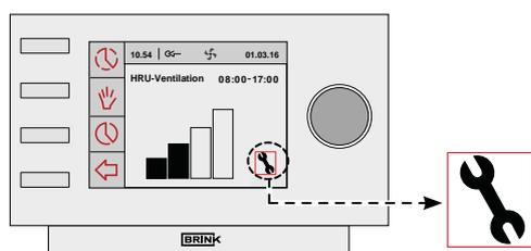
Zjistí-li zařízení nezávažnou poruchu, bude nadále pokračovat v (omezené) činnosti. Na displeji se zobrazí symbol poruchy (klíč). Chybové hlášení je možno si přečíst v nabídce Hlášení.
