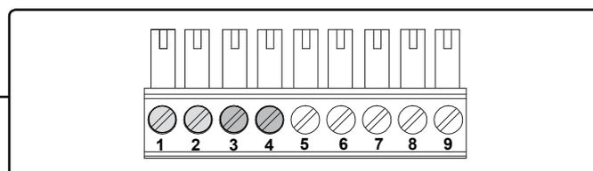
Připojení č. 3 a 4 jsou standardními vstupy 0-10 V; v případě potřeby jako vstupy 0-10 V možno použít i připojení č. 1 a 2.
