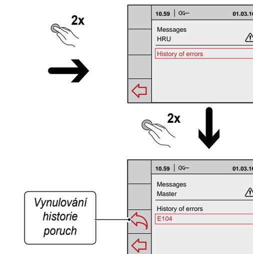
K odstranění této poruchy kontaktujte servisního technika. Závažnou poruchu není možno vyřešit odpojením zařízení z elektrické sítě; poruchu je nutné nejdříve odstranit.
