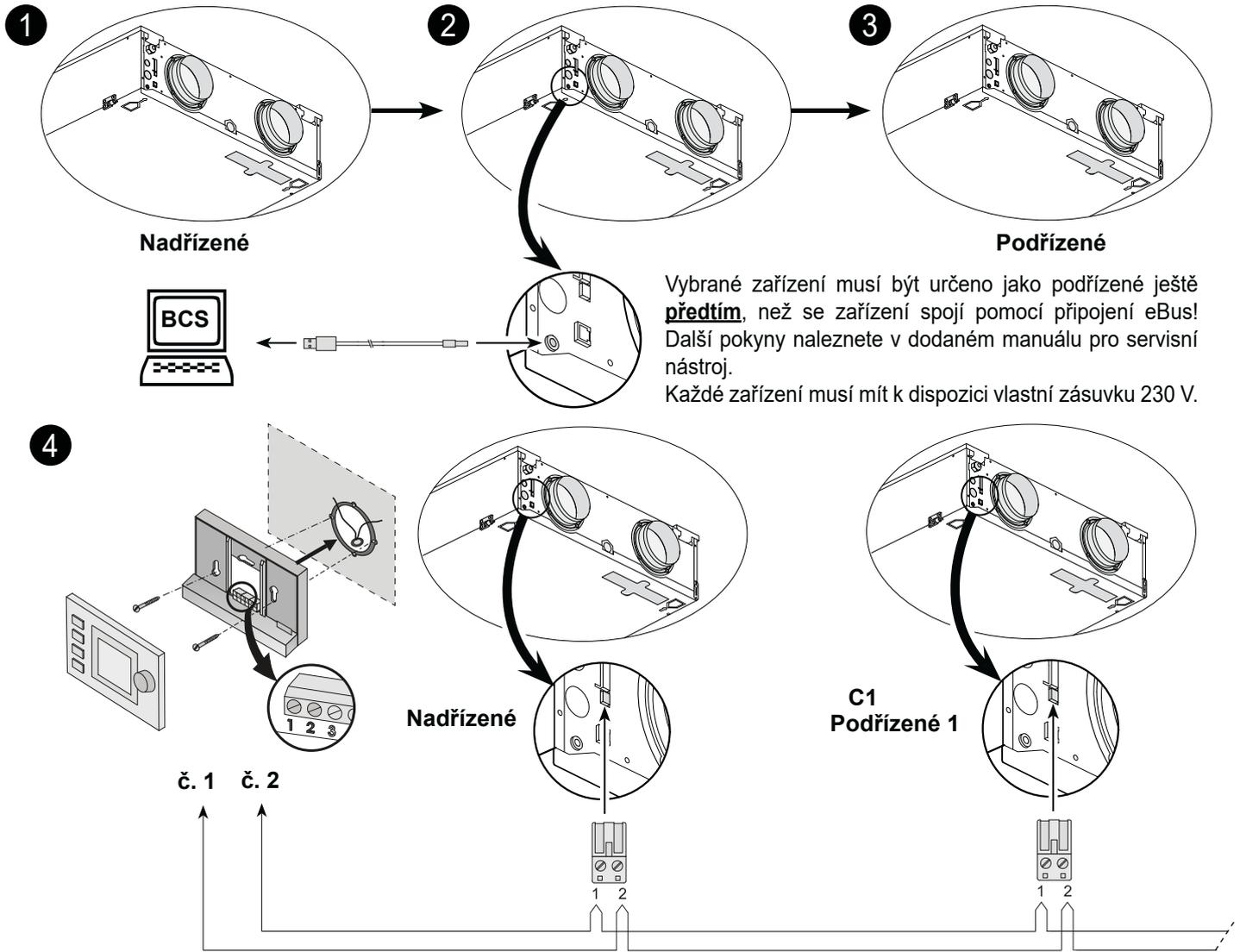
Vybrané zařízení musí být určeno jako podřizené ještě **předtím**, než se zařízení spojí pomocí připojení eBus! Další pokyny naleznete v dodaném manuálu pro servisní nástroj. Každé zařízení musí mít k dispozici vlastní zásuvku 230 V.
