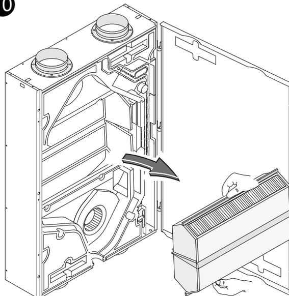
Při montáži na strop opatrně odstraňte zásobník na kondenzát – pořád se v něm mohou nacházet zbytky kondenzátu!
