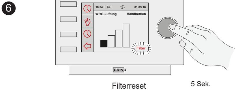
Ein Filter-Reset kann auch mit dem 4-Stufenschalter durch 4-maliges Umschalten (Normalgeschwindigkeit) zwischen Position 1 und 0 oder 0 und 1 durchgeführt werden. Ein erfolgreicher Filter-Reset wird durch kurzes Blinken der roten LED bestätigt.
