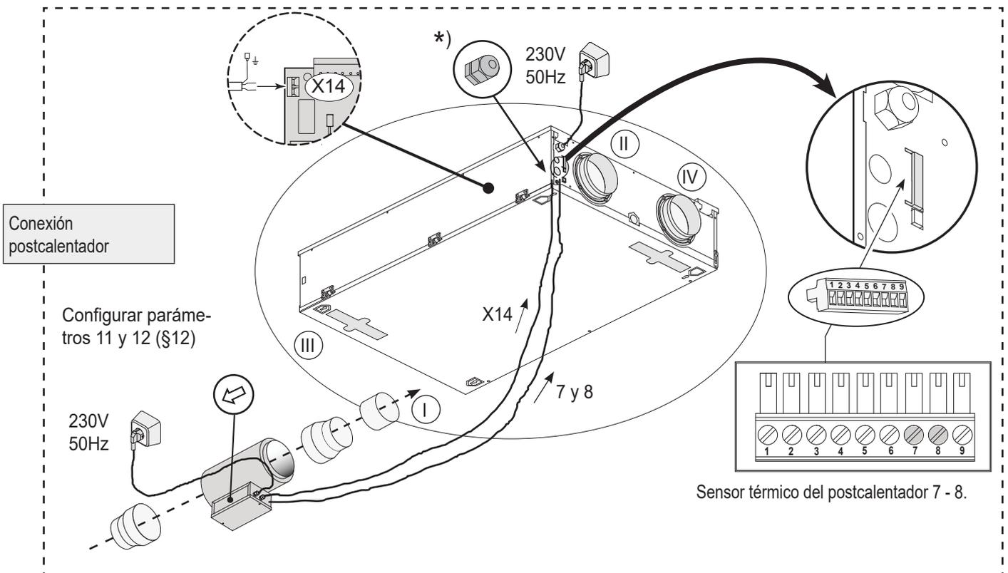
\*) Descargador de tensión colocado por el instalador (no se entrega con el equipo) para conducto de paso de cable 230 V a postcalentador o precalentador extra
