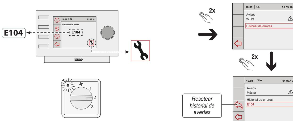
Si el equipo advierte de una avería con bloqueo, el aparato dejará de funcionar. En la pantalla (iluminada permanentemente) se mostrará el símbolo de avería (llave) junto a un código de avería. En el interruptor de modo (si lo hubiera) se pondrá a parpadear el piloto rojo.
