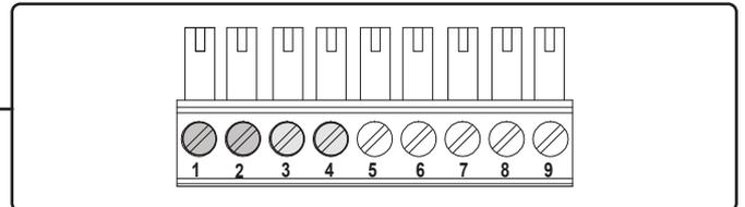
Las conexiones núm. 1 y 2 son los contactos del interruptor externo de forma estándar; también se pueden configurar las conexiones núm.3 y 4 como contacto de interruptor externo.
