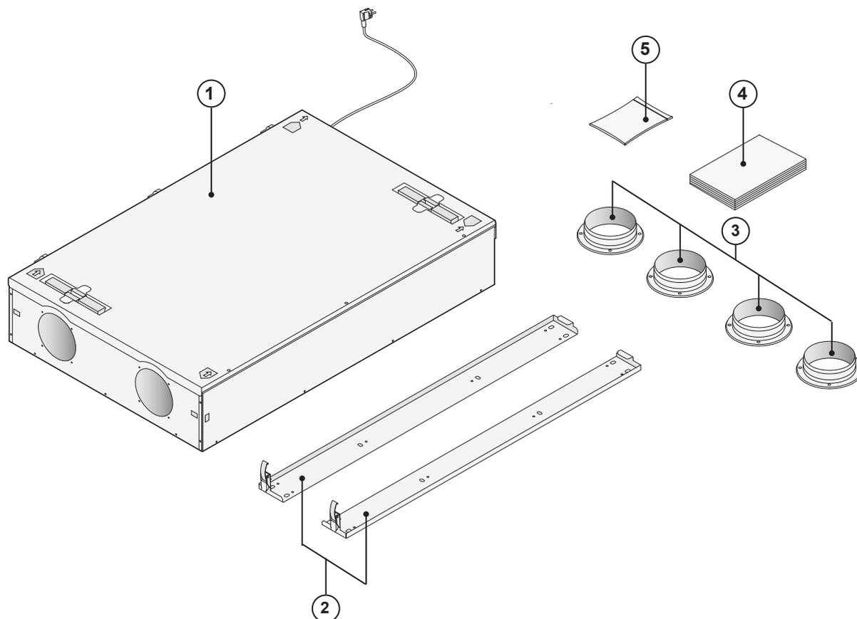
Antes de empezar con la instalación del equipo de retorno térmico, compruebe que esté completo y sin daños. El paquete de entrega del equipo de retorno térmico modelo Renovent Sky 150 se compone de lo siguiente:
