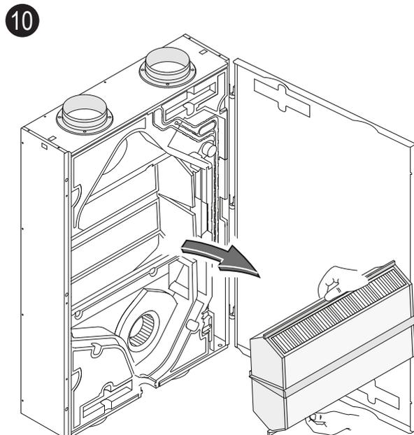
En el caso de montaje de techo soltar la bandeja de condensación con cuidado; puede tener bastante agua de condensación.
