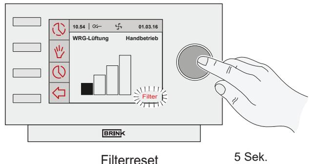
Ein Filter-Reset kann auch mit dem 4-Stufenschalter durch 4-maliges Umschalten (Normalgeschwindigkeit) zwischen Position 1 und 0 oder 0 und 1 durchgeführt werden. Ein erfolgreicher Filter-Reset wird durch kurzes Blinken der roten LED bestätigt.
