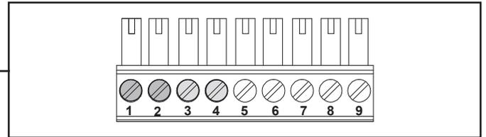
Verbindung Nr. 1 und Nr. 2 Standard externer Schaltkontakt, Nr. 3 und Nr. 4 sind optional. Verbindung kann auch als externe Schaltkontakt verwendet werden.
