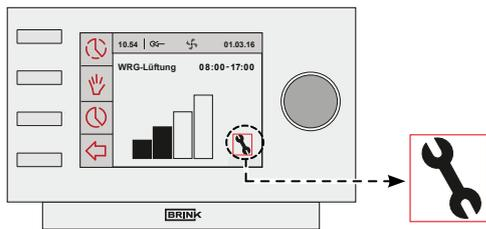
Wenn das Gerät eine nicht-sperrende Störung erkennt, wird es noch (beschränkt) weiterhin funktionieren. Im Display wird das Störungssymbol (Schlüssel) angezeigt. Im dem Menü "Meldungen" kann diese Störung ausgelesen werden.
