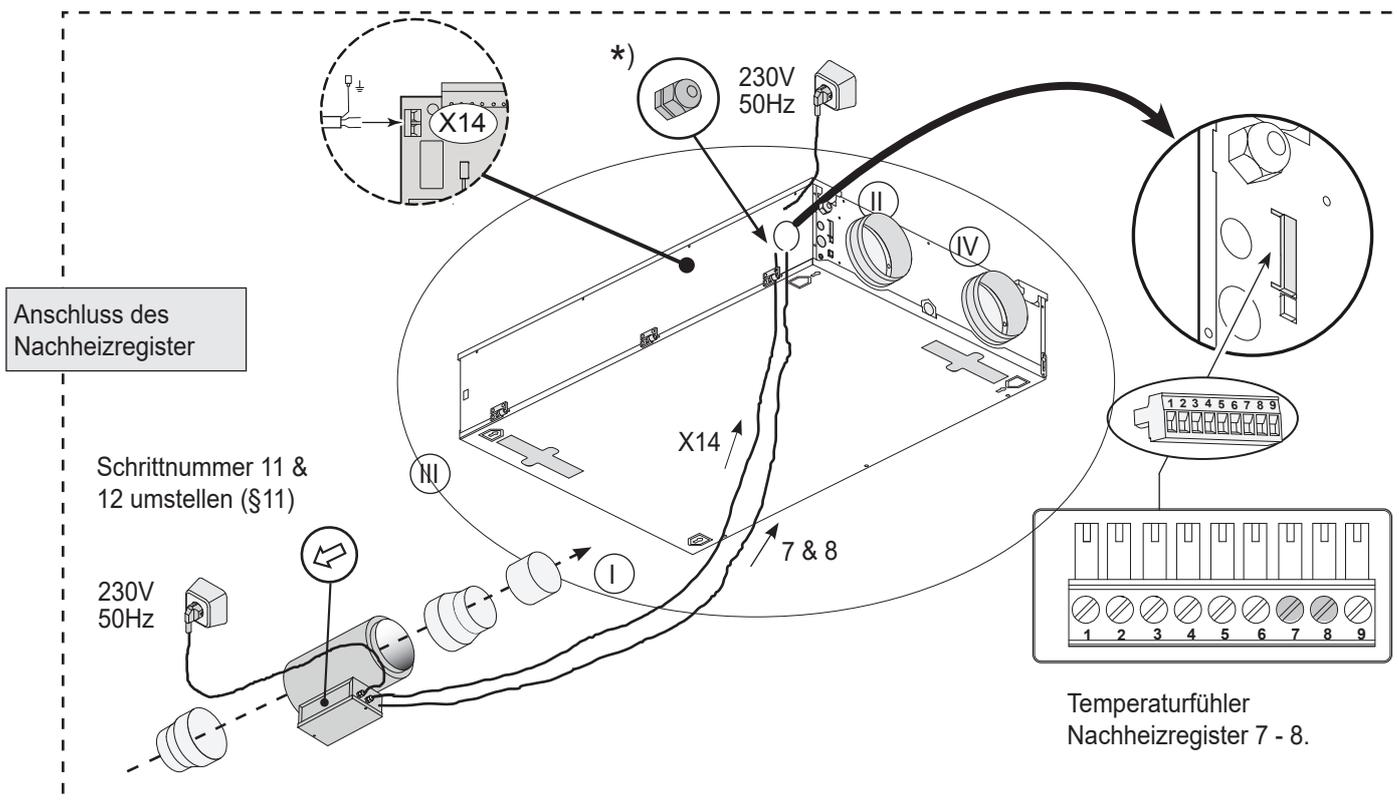
\*) Um ein zweites Vorheizregister oder Nachheizregister zu installieren benötigt man für die Durchführung des 230V Kabels einen Durchführungsstippel (nicht im Lieferumfang enthalten).
