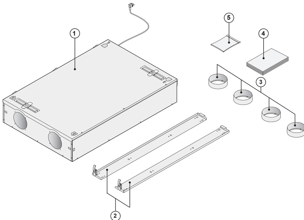
Bitte überprüfen Sie, bevor Sie mit der Installation des Wärmerückgewinnungsgeräts beginnen, ob es komplett und unbeschädigt geliefert wurden. Der Lieferumfang des Wärmerückgewinnungsgeräts vom Typ Renovent Sky 200 Plus Enthalpy umfasst folgende Komponenten:
