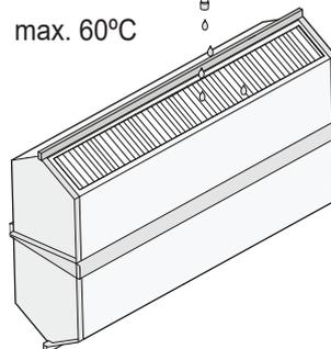
Der Wärmetauscher muss regelmäßig auf Verschmutzungen überprüft und bei Bedarf gereinigt werden. Zum Erhalten der latenten Wirksamkeit muss der Wärmetauscher mindestens einmal pro Jahr gereinigt werden.
