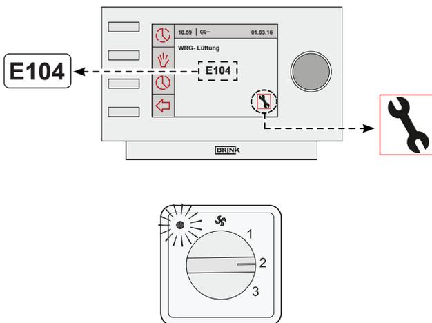
Wenn das Gerät eine Sperrstörung erkennt, wird es nicht mehr funktionieren. Im (permanent beleuchteten) Display wird das Störungssymbol (Schlüssel) zusammen mit einem Störungscode angezeigt. Am Stufenschalter (sofern zutreffend) wird die
