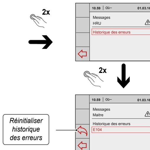
sélecteur de position (le cas échéant), clignotera. Contacter l'installateur pour résoudre ce dérangement. Un dérangement verrouillant ne se résout pas en mettant l'appareil hors tension ; le dérangement doit tout d'abord être résolu.
