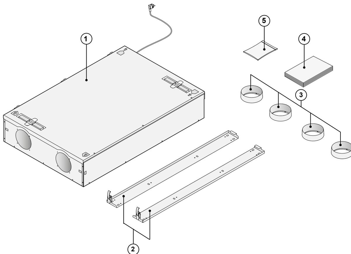
Avant de commencer l'installation de l'appareil à récupération de chaleur, veuillez contrôler s'il a été livré complet et intact. Le contenu de la livraison de l'appareil à récupération de chaleur Renovent Sky 200 est composé des éléments suivants:
