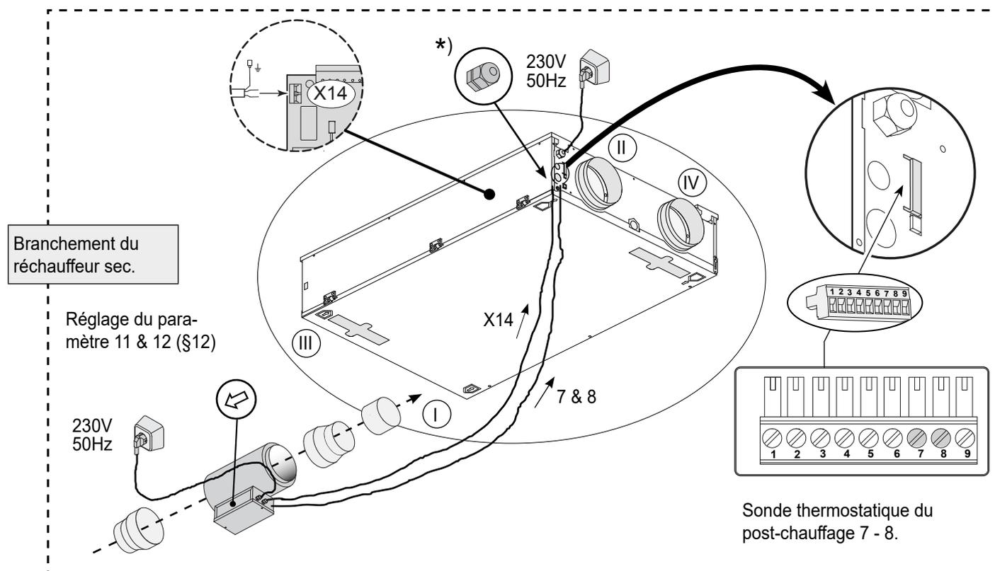
\*) Dispositif anti-arrachement (non fourni avec l'appareil) pour le passage de câbles d'alimentation 230 volt vers le post-chauffage ou le préchauffeur supplémentaire.
