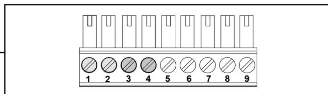
Branchements n° 3 et n° 4 pour entrée 0-10 volt ; en option les branchements n° 1 et n° 2 peuvent aussi être utilisés comme entrée 0-10 volt.
