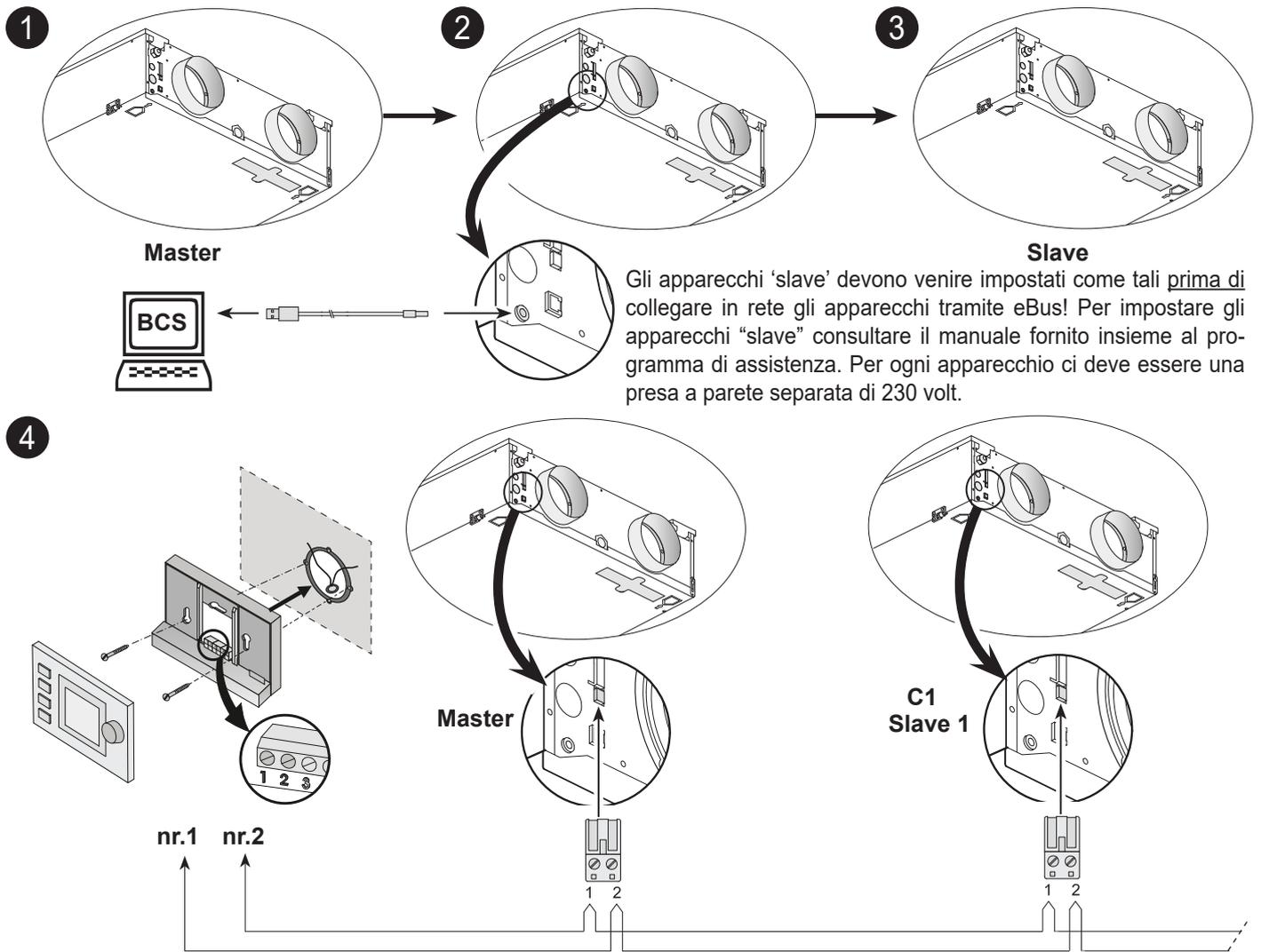
Gli apparecchi 'slave' devono venire impostati come tali prima di collegare in rete gli apparecchi tramite eBus! Per impostare gli apparecchi "slave" consultare il manuale fornito insieme al programma di assistenza. Per ogni apparecchio ci deve essere una presa a parete separata di 230 volt.
