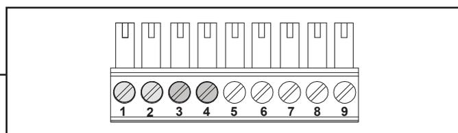
Collegamento n. 3 e n. 4 ingresso standard 0-10 volt; uso opzionale del collegamento n.1 e n.2 come ingresso 0-10 volt.
