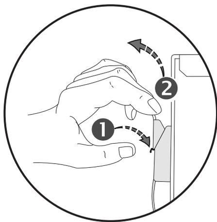
5.2.2 Rimozione dell'apparecchio dalle staffe di montaggio
