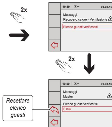
l'apparecchio dalla tensione: occorre prima rimediare al guasto. L'apparecchio rimane in questo stato fino a quando non verrà risolto il problema. Successivamente l'apparecchio effettuerà un ripristino automatico e il display tornerà alla modalità normale di funzionamento.
