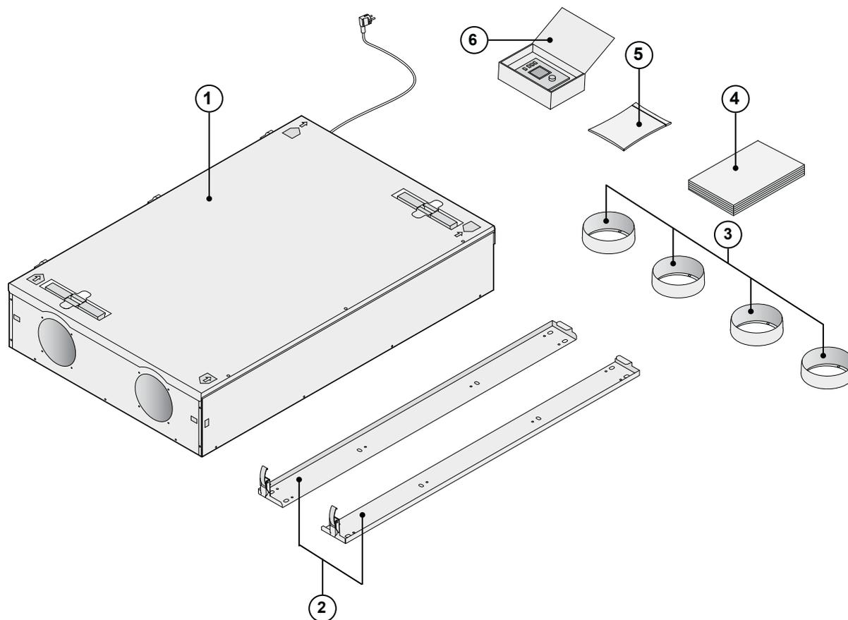
Prima di iniziare l'installazione, controllare che l'apparecchio di ventilazione con recupero di calore sia completo e integro. La fornitura dell'apparecchio di ventilazione con recupero di calore Renovent Sky 200 comprende i seguenti componenti:
