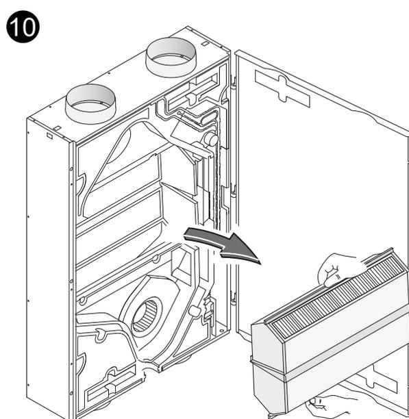
In caso di montaggio a soffitto rimuovere con cautela il contenitore della condensa; può esserci ancora una piccola quantità di acqua di condensa nel contenitore!
