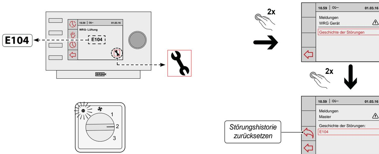
rote LED blinken. Setzen Sie sich bitte mit dem Installateur in Verbindung, um diese Störung zu beheben. Eine Sperrstörung lässt sich nicht aufheben, indem man das Gerät kurz spannungslos macht. Zunächst ist die Störung zu beheben.
