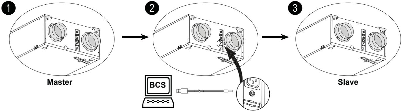
Die Slave-Geräte müssen als Slave eingestellt werden, bevor die Geräte über eBus miteinander verbunden werden! Für die richtige Einstellung der 'Slave'-Geräte siehe die zum Service-Tool mitgelieferte Anleitung. Für jedes Gerät muss eine separate 230V-Wandsteckdose vorhanden sein.
