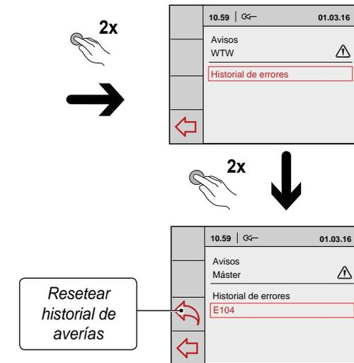
Póngase en contacto con el instalador para solucionar la avería. Una avería con bloqueo no se soluciona retirando la tensión del aparato; hay que solucionar la avería.
