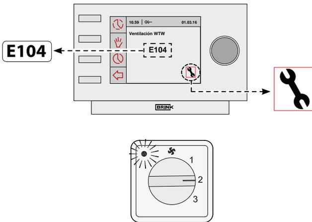
Si el equipo advierte de una avería con bloqueo, el aparato dejará de funcionar. En la pantalla (iluminada permanentemente) se mostrará el símbolo de avería (llave) junto a un código de avería. En el interruptor de modo (si lo hubiera) se pondrá a parpadear el piloto rojo.
