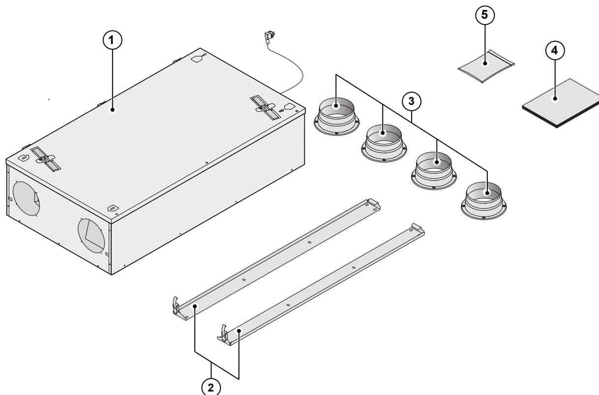
Antes de empezar con la instalación del equipo de retorno térmico, compruebe que esté completo y sin daños. El paquete de entrega del equipo de retorno térmico modelo Renovent Sky 300 se compone de lo siguiente:
