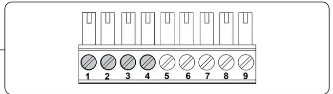
Las conexiones núm.1 y 2 son los contactos del interruptor externo de forma estándar; también se pueden configurar las conexiones núm.3 y 4 como contacto de interruptor externo.
