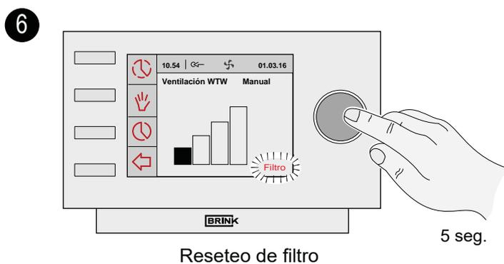
También se puede realizar un reinicio del filtro con el interruptor de 4 vías cuando se cambia 4 veces (a velocidad normal) entre la posición 1 y 0 o 0 y 1. Un reinicio exitoso del filtro se confirma mediante un breve destello del LED rojo.
