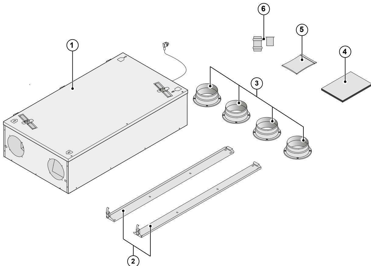
Pred začetkom vgradnje prezračevalnega sistema z vračanjem toplote preverite, ali je dobava celotna in nepoškodovana. Obseg dobave prezračevalnega sistema z vračanjem toplote Renovent Sky 300 vključuje naslednje dele:
