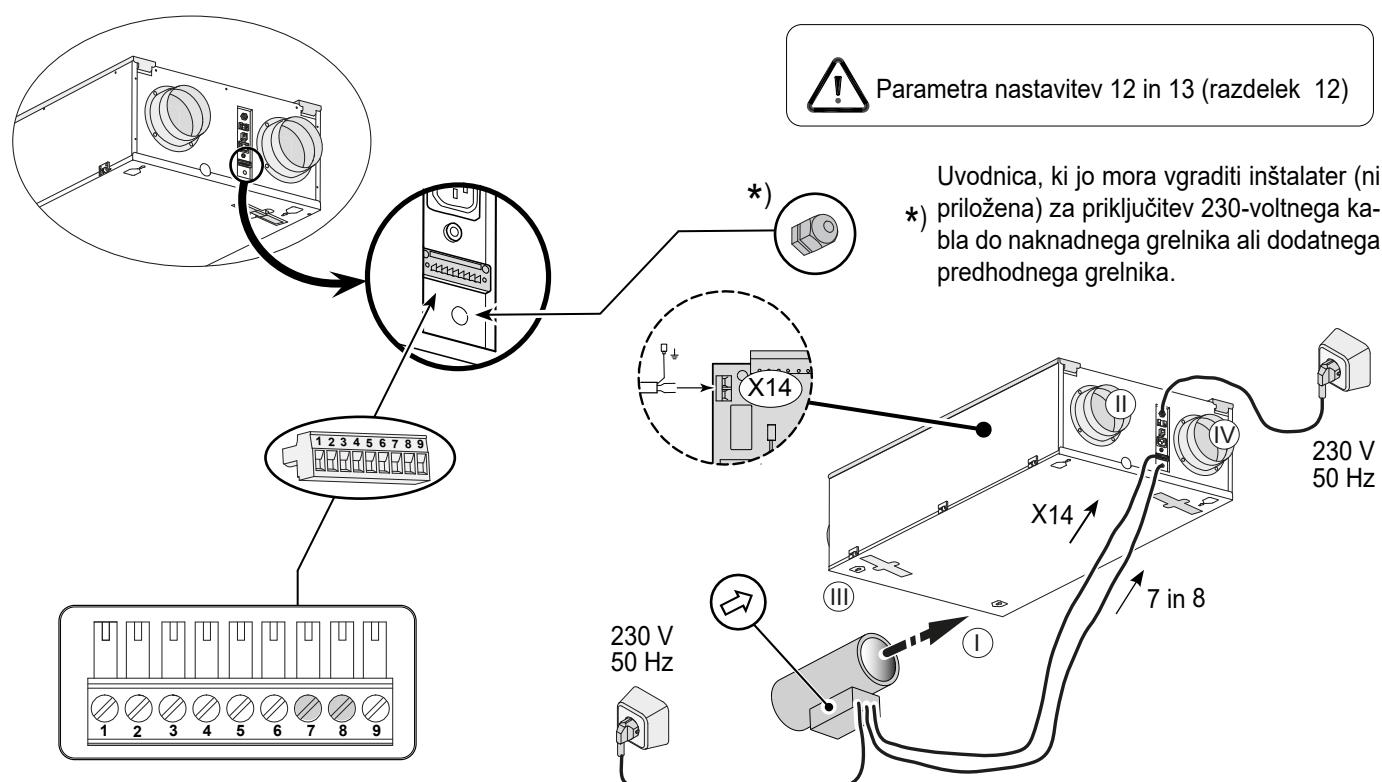
10.7 Priključitev topotnega izmenjevalnika za geosondo
