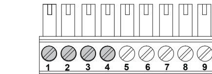
Připojení č. 1 a 2 jsou standardními kontakty externího přepínače; v případě potřeby je jako kontakty externího přepínače použít i připojení č. 3 a 4.
