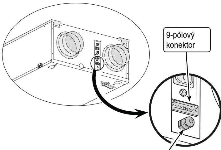
Díru pro průchodku namontuje servisní technik (pro objímku kabelu dohřívacího registru/dalšího předehřívacího registru)
