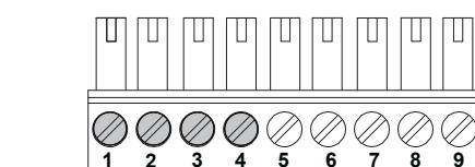
Připojení č. 3 a 4 jsou standardními vstupy 0-10 V; v případě potřeby jako vstupy 0-10 V možno použít i připojení č. 1 a 2.
