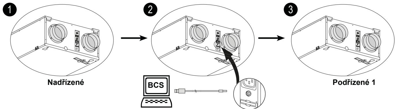
Vybrané zařízení musí být určeno jako podřízené ještě předtím, než se zařízení spojí pomocí připojení eBus! Další pokyny najeznete v dodaném manuálu pro servisní nástroj.
