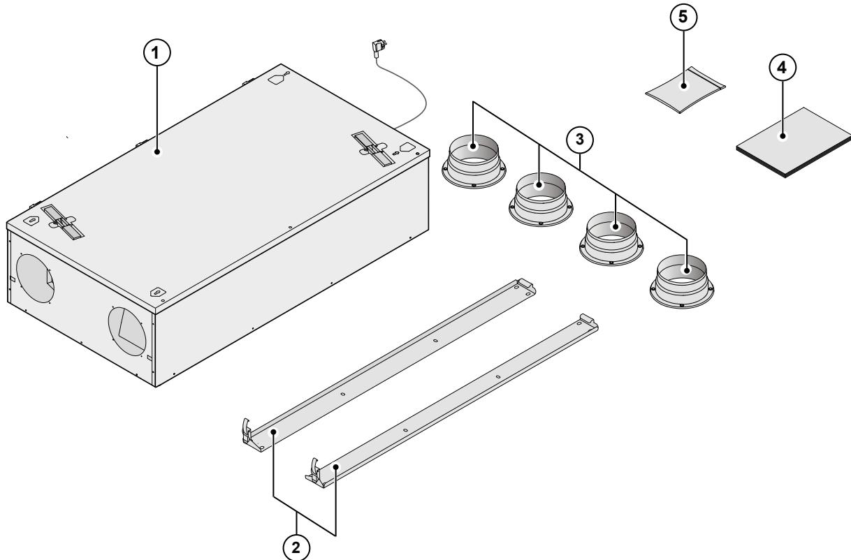
Před montáží této rekuperacní jednotky se ujistěte, zda byla dodána kompletní a nepoškozená. Součástí dodávky větrací jednotky s rekuperací tepla Renovent Sky 300 jsou tyto komponenty:
