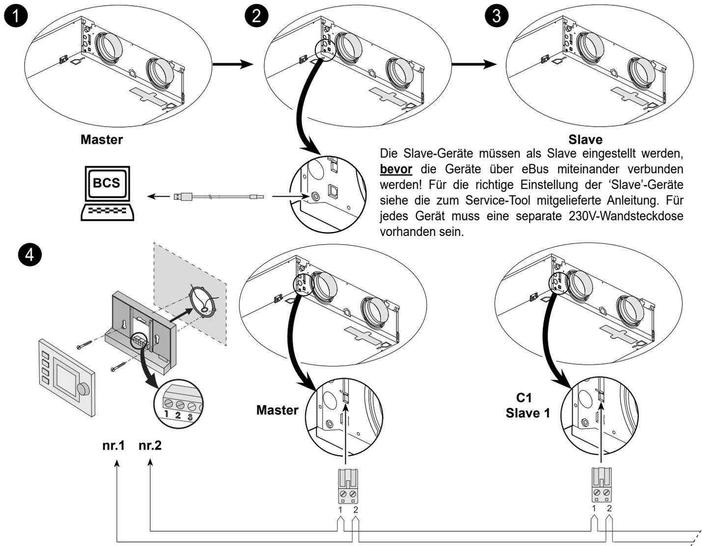
Die Slave-Geräte müssen als Slave eingestellt werden, **bevor** die Geräte über eBus miteinander verbunden werden! Für die richtige Einstellung der 'Slave'-Geräte siehe die zum Service-Tool mitgelieferte Anleitung. Für jedes Gerät muss eine separate 230V-Wandsteckdose vorhanden sein.
